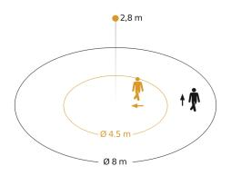
Possibile altezza di montaggio: 2,00 m - 4,00 m Arancione: radiale
